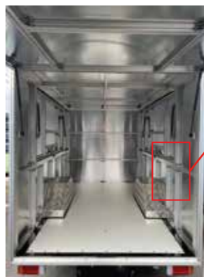
■ T-100は30×30mm アルミフレーム構造 全体の強度も高くなっています。
