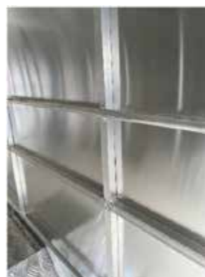
■ T-99は20×20mmの アルミフレーム構造
