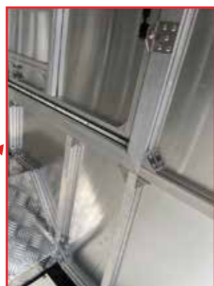
■ T-100は30×30mm アルミフレーム構造 全体の強度も高くなっています。
